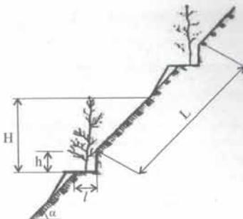
Профиль ступенчатых площадок на горном склоне: Н – высота деревьев, м;  $h$  – глубина вертикального вреза площадки, м;  $l$  – ширина горизонтального вреза полотна площадки;  $\alpha$  – крутизна склона;  $L$  – расстояние между площадками.
